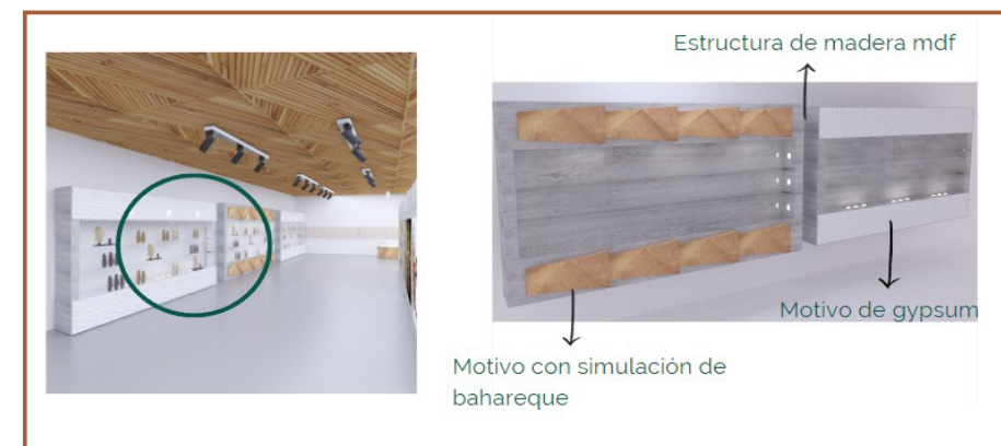
Detalle de mobiliario - Sala de Exposición 2
