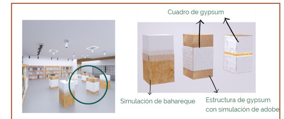
Detalle de mobiliario - Sala de Exposición 4
