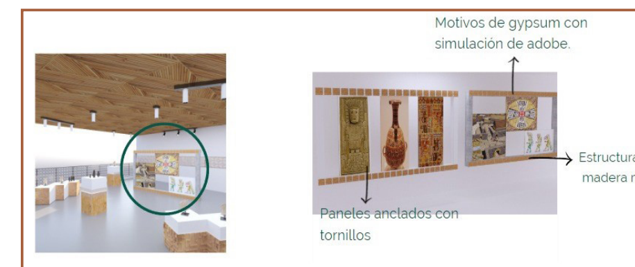
Detalle de mobiliario - Sala de Exposición 1
