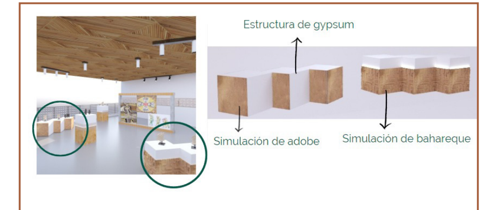
Detalle de mobiliario - Sala de Exposición 1
