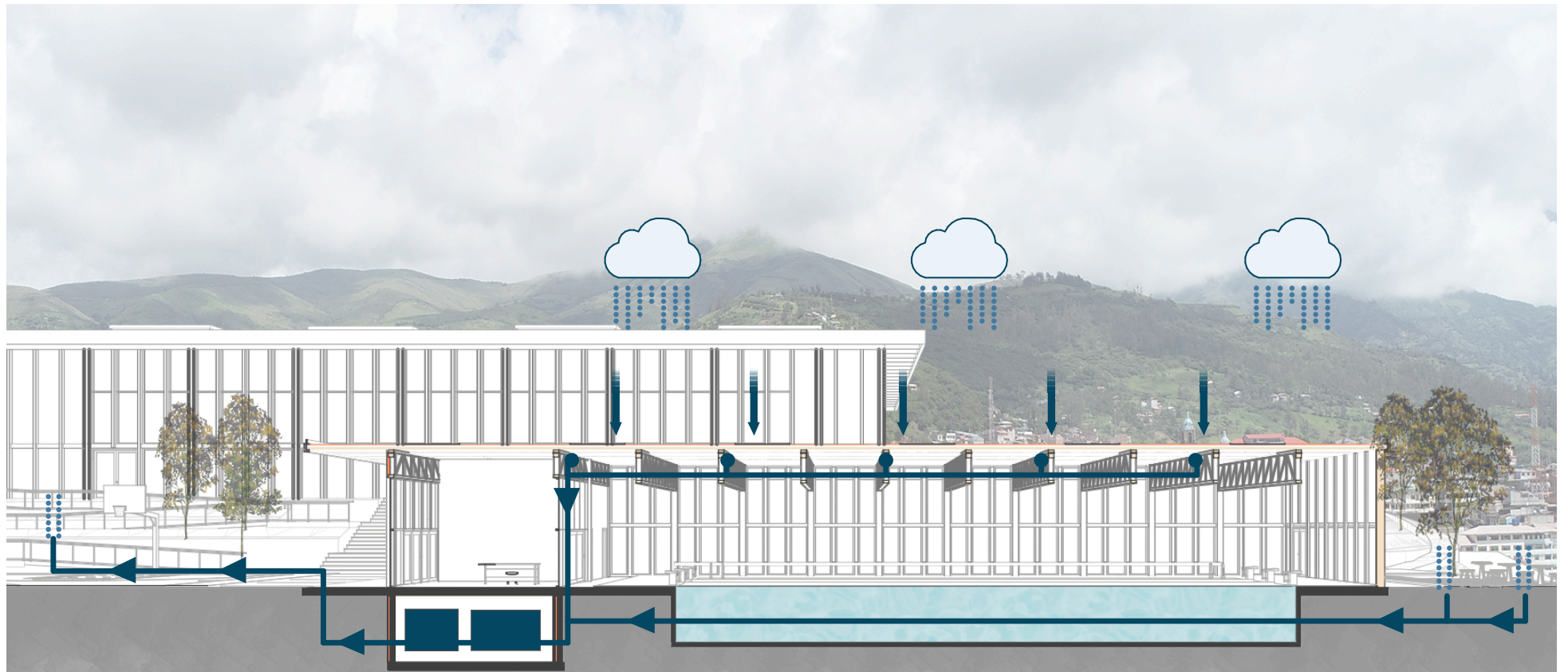
Imagen 48. Sistema de captación de aguas lluvias del bloque de piscina
