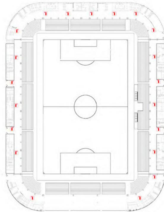
Imagen 112: Planta de extintores de fuego planta baja. Fuente: Elaboración propia.
