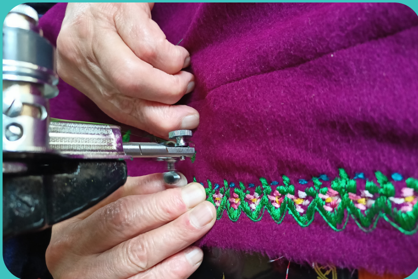
Figura 54. Bordado con máquina de pedal. (Autoría propia, 2022).
