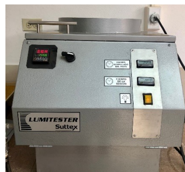
Figura 127 Equipo Lumitester que contiene luz artificial de xenón
