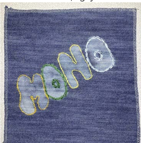
Figura 99. Muestra 7. Devoré sobre denim, cloro y bordado a mano de la letra Fuente: Autoría propia (2022).
