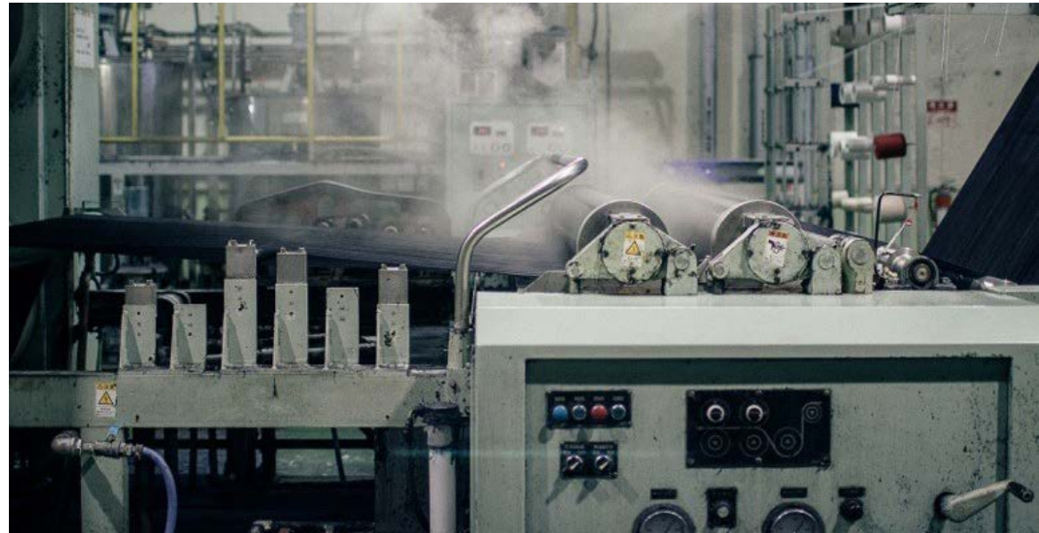
Figura 6. Engomado del hilo (Mil dedales,2016)
