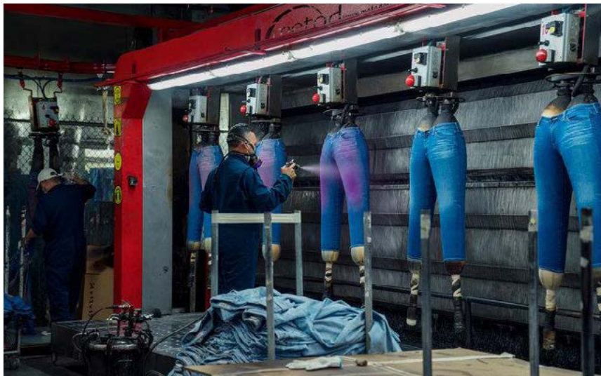
Figura 20. Proceso sand blast químico. (CHEING, PHILIP)
