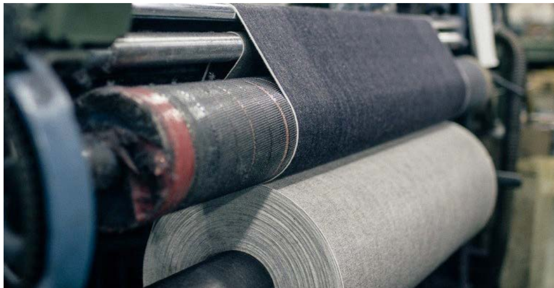
Figura 7. Sanforizado del tejido (Mil dedales,2016)
