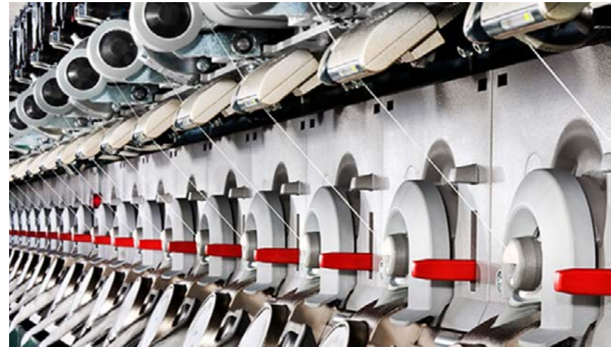
Figura 4. Hilado open end (Dalmau,2020)
