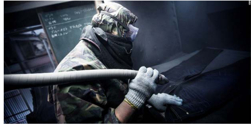
Figura 18. Proceso de Sandblasting (Textile education, s.f.)
