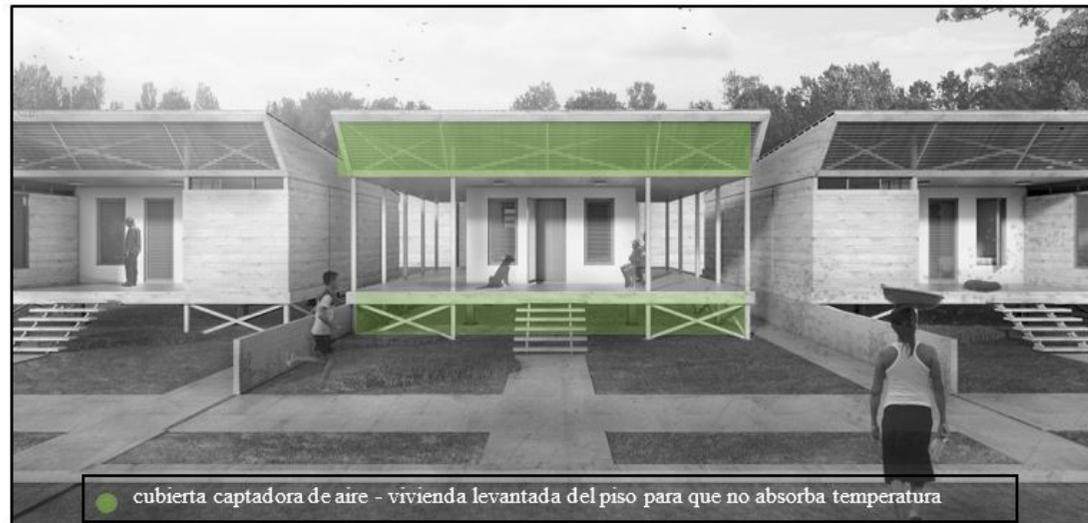
● cubierta captadora de aire - vivienda levantada del piso para que no absorba temperatura
