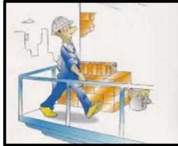
Son de material duro y resistente, tienen una altura mínima desde el suelo de 90 cm, completos de rodapiés de altura mínima de 15 cm y provistos de soportes fijos. Deben instalarse con una distancia de 2,5 m entre ellos y una capacidad de carga de 150 kg por metro para garantizar su estabilidad.
