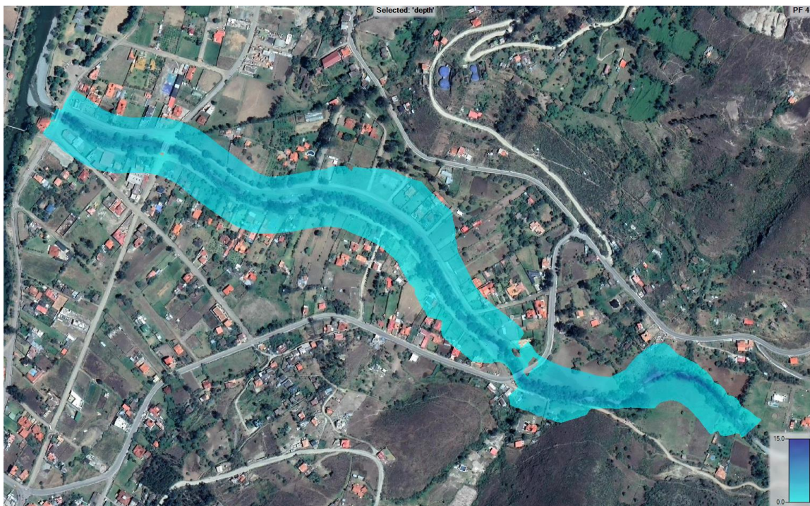
Figura 3.17. Vista en planta de la mancha de inundación para un TR=25 años.
