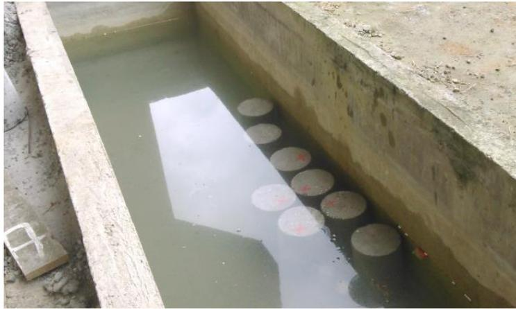
*Figura 5.16. Curado de los cilindros de hormigón*
