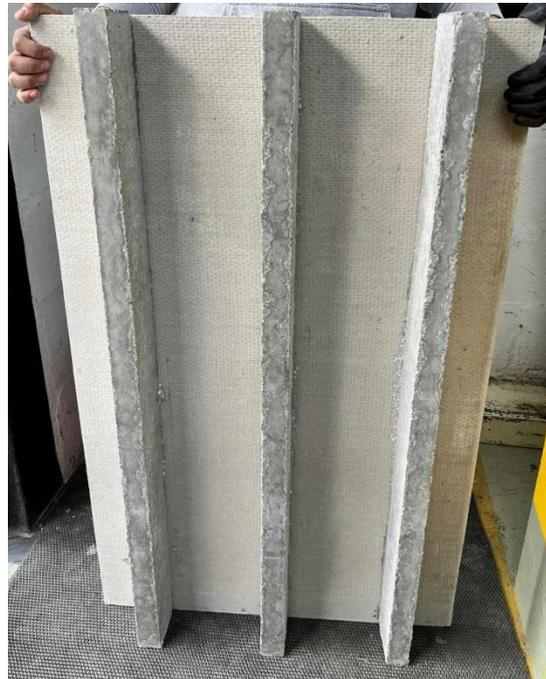
*Figura 6.2. Vista inferior de la losa micronervada de tres nervios*
