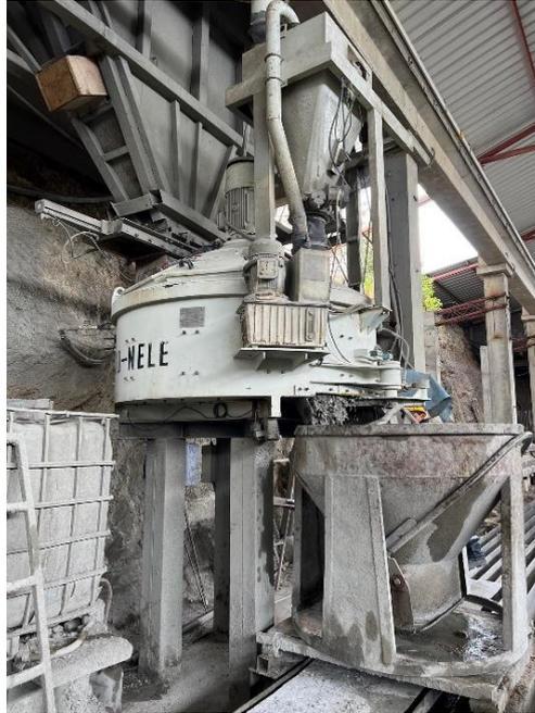
*Figura 5.8. Preparación de la mezcla de hormigón*
