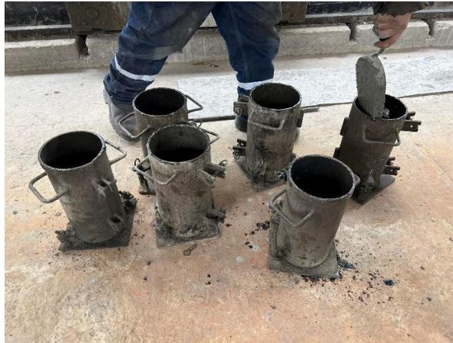
*Figura 5.13. Vertido del hormigón en tres capas*
