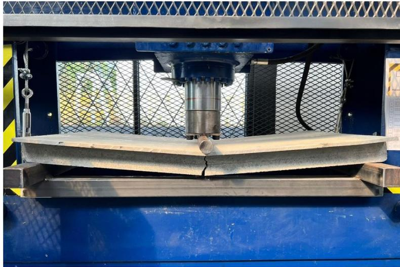
Figura 6.22. Losa # 2 (cuatro nervios). Carga aplicada y fisuras originadas
