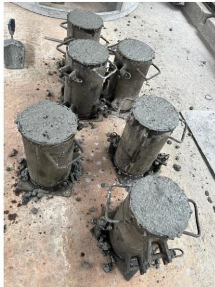
*Figura 5.15. Resultado de la toma de muestras de los cilindros de hormigón*
