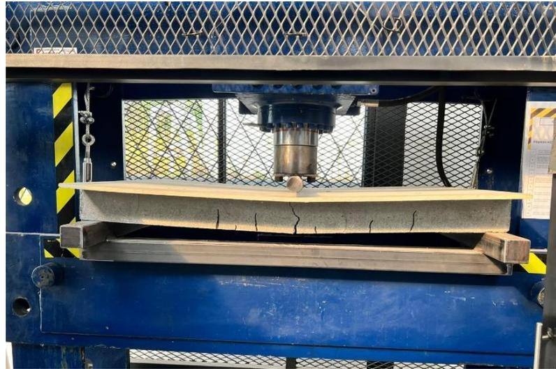
*Figura 6.12. Losa # 1 (tres nervios). Carga aplicada y fisuras originadas*
