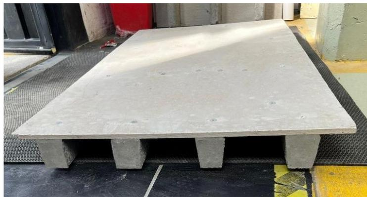
*Figura 6.3. Vista frontal de la losa micronervada de cuatro nervios*
