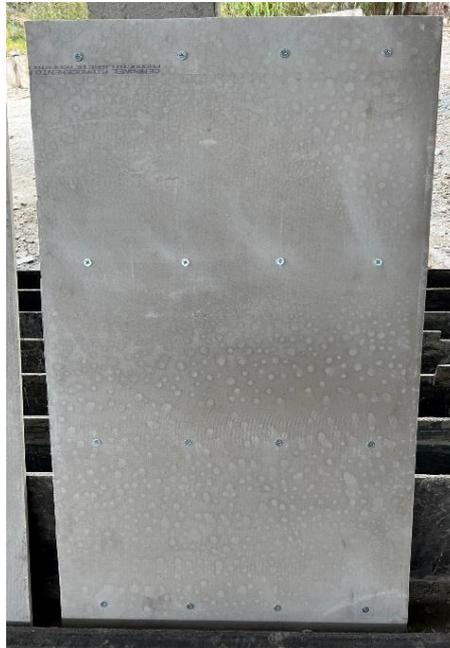
*Figura 5.7. Plancha de fibrocemento con conectores para la losa de cuatro nervios*
