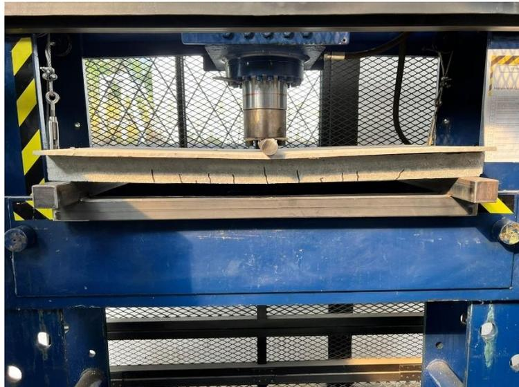
Figura 6.16. Losa # 3 (tres nervios). Carga aplicada y fisuras originadas
