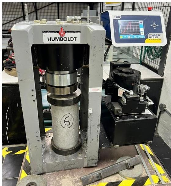
*Figura 6.8. Colocación de las probetas cilíndricas en la prensa hidráulica.*
