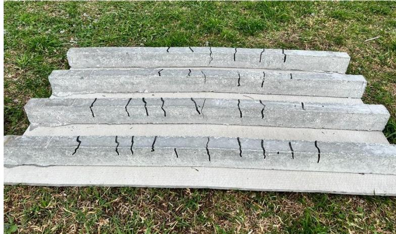
Figura 6.20. Grietas formadas en la losa # 1 de cuatro nervios.
