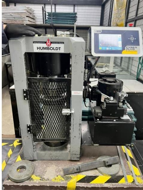
*Figura 6.9. Aplicación de la carga en los cilindros de concreto*
