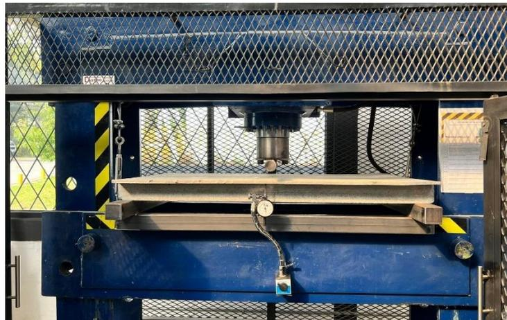
Figura 6.19. Instalación de las losas de tres nervios en la prensa hidráulica
