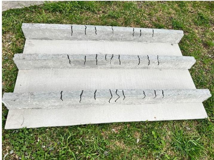
Figura 6.14. Grietas originadas en la losa # 2 de tres nervios
