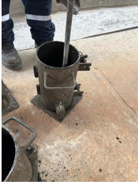
*Figura 5.14. Compactación de los cilindros*
