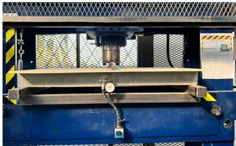
Figura 6.11. Instalación de las losas de tres nervios en la prensa hidráulica
