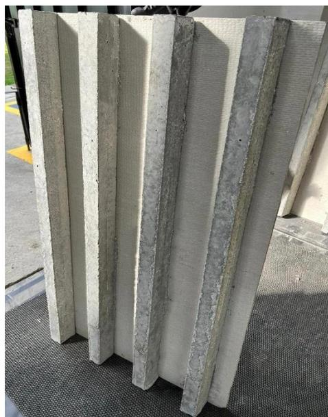
*Figura 6.4. Vista inferior de la losa micronervada de cuatro nervios*
