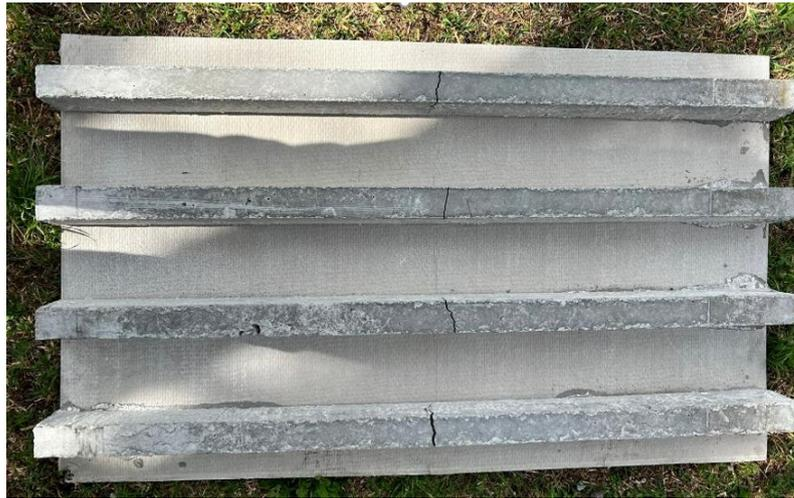
Figura 6.24. Grietas de la losa # 3 de cuatro nervios
