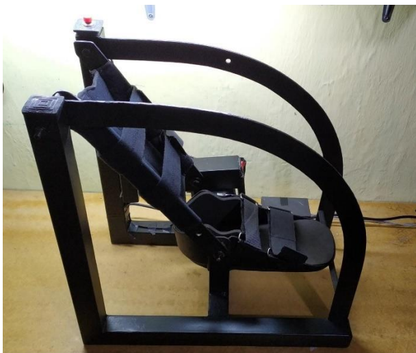
Figura 27. Dispositivo asistente de rehabilitación
