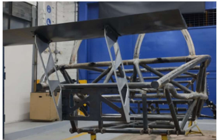
Figura 16: Ensamble final de los accesorios en el chasis del vehículo eléctrico biplaza. Fuente: Autores.
