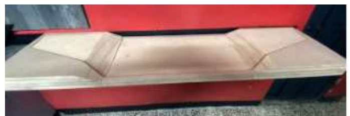
Figura 9: Molde inferior alerón delantero construido en CNC. Fuente: Autores.
