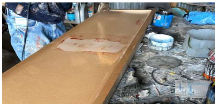
Figura 10: Barnizado del molde alerón trasero. Fuente: Autores.
