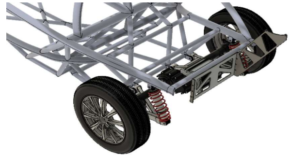
Figura 8: Integración CAD anclaje alerón trasero. Fuente: Autores.
