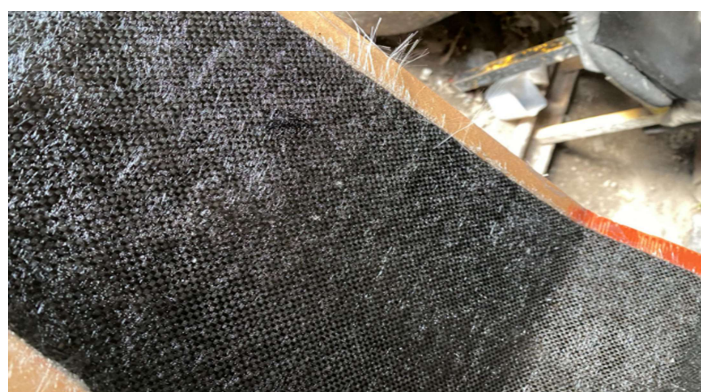
Figura 13: Colocación de las capas de las fibras a utilizar en los accesorios. Fuente: Autores.
