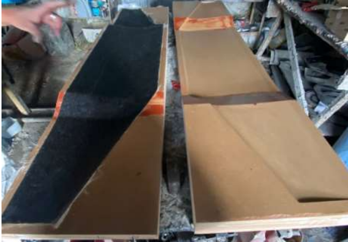
Figura 14: Proceso de desmoldado del alerón delantero. Fuente: Autores.
