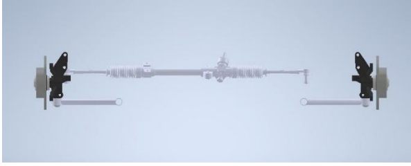
Figura 12: Simulación de la cremallera y articulaciones. Fuente: Autores.
