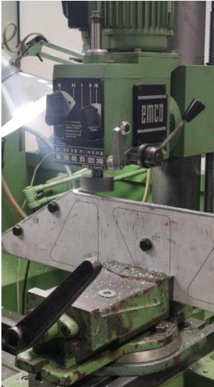
Fig. 26 Eliminación de rebabas
