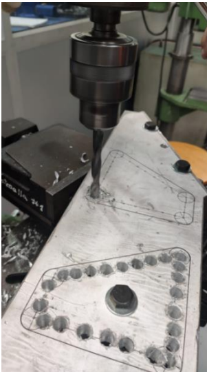
Fig. 27 Taladrado de la parte interna del soporte del alerón
