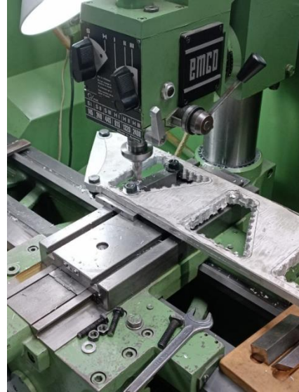
Fig. 28 Eliminación de los cantos vivos internos del soporte del alerón
