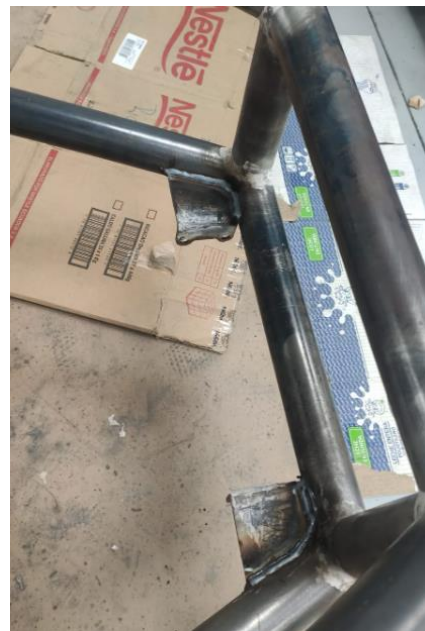
Fig. 33 Soldadura de las placas para los soportes delanteros del alerón
