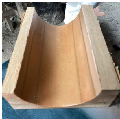
Fig. 11 Adecuación del molde.
