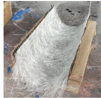
Fig. 16 Refuerzo con fibra de vidrio
