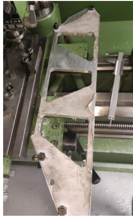
Fig. 29 Parte interna del soporte terminada
