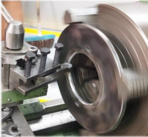
Fig. 15. Fabricación soporte circular de sujeción muelle tipo MacPherson.
