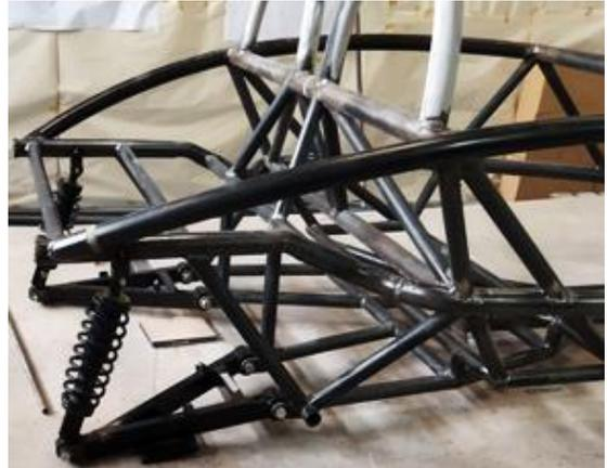
Fig.22. Ensamble de suspensión posterior. Fuente: Autores.
