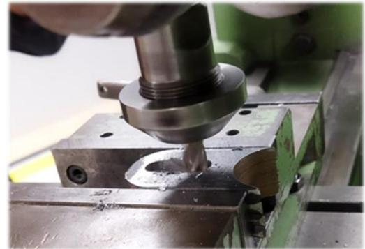
Fig. 13. Manufactura del soporte desbaste del material
