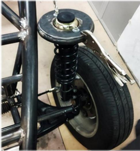
Fig. 16. Colocación del soporte de sujeción de la cazoleta
