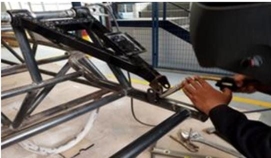
Fig. 21. Ubicación de soportes superiores de amortiguadores posteriores. Fuente: Autores
