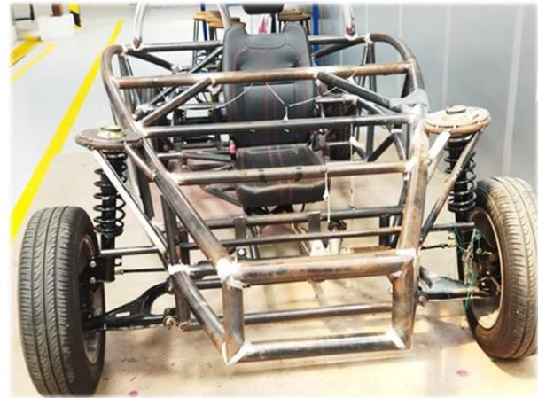
Fig. 17. Ubicación de soportes con tubos estructurales
