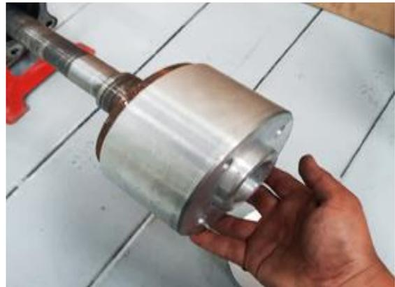
Fig. 23. Expansores de ruedas posteriores. Fuente: Autores.
