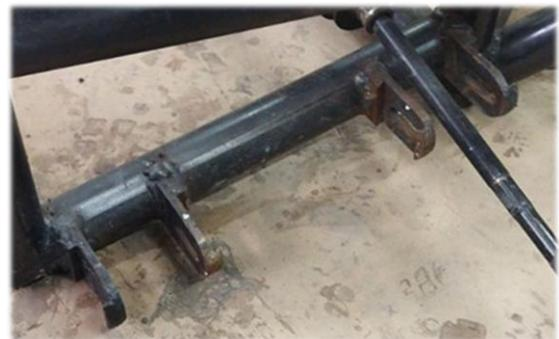
Fig. 14. Ubicación de soportes con el chasis
