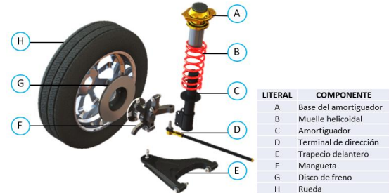
Fig 4. Vista explosionada de suspensión delantera McPherson
