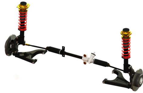
Fig 3. Modelo CAD de suspensión delantera McPherson
