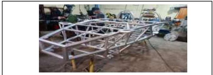
Fig. 10. Acabado final de la pintura sobre el chasis.
