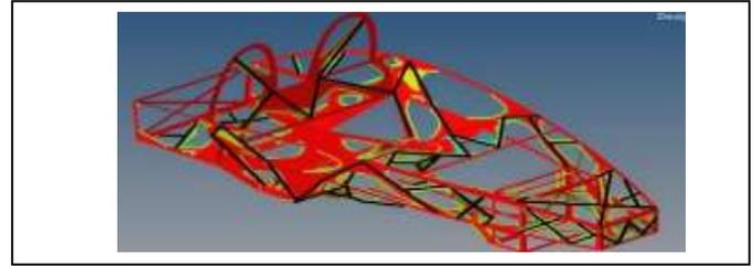
Fig. 1. Obtención del sistema alámbrico que conformará el chasis, [7].
