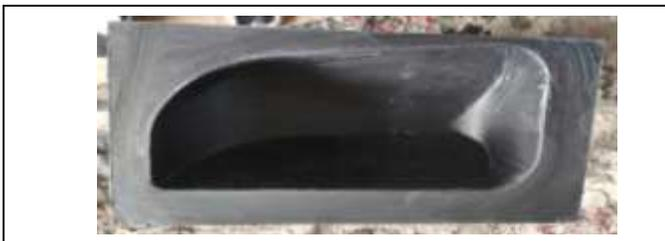
Fig. 17. Obtención de la carcasa a partir del molde..
