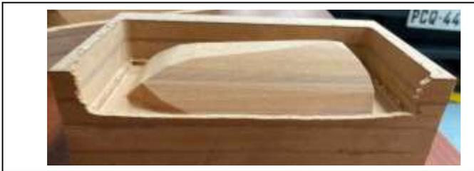
Fig. 16. Fabricación de molde de espejo retrovisor en CNC.
