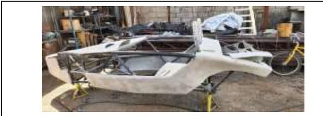
Fig. 11. Montaje de carenado sobre el chasis.
