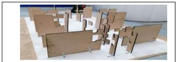
Fig. 8. Matriz del montaje de chasis.
