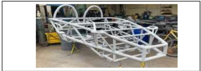
Fig. 9. Aplicación de capa de pintura de fondo del chasis.
