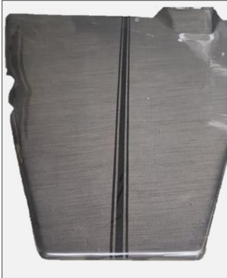
**Fig. 11.** Capot de fibra de carbono terminado.
