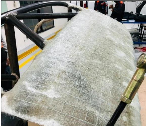
**Fig. 4.** Aplicación de material compuesto sobre la malla.
