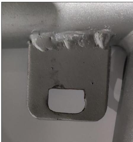
**Fig. 12.** Placa de sujeción del carenado soldada al chasis.
