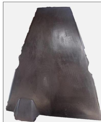
**Fig. 10.** Capot de fibra de carbono desmoldado.
