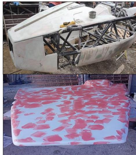
**Fig. 6.** Corrección de fallas existentes en el carenado.
