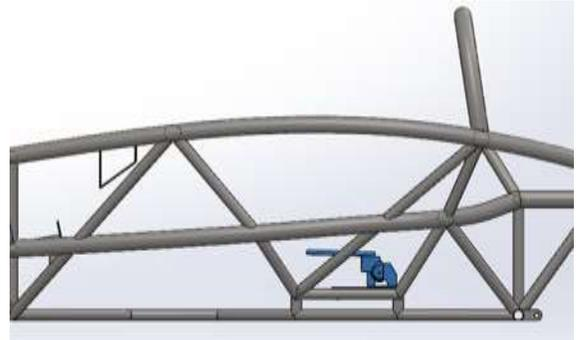
Fig. 12. Freno de mano diseñado
