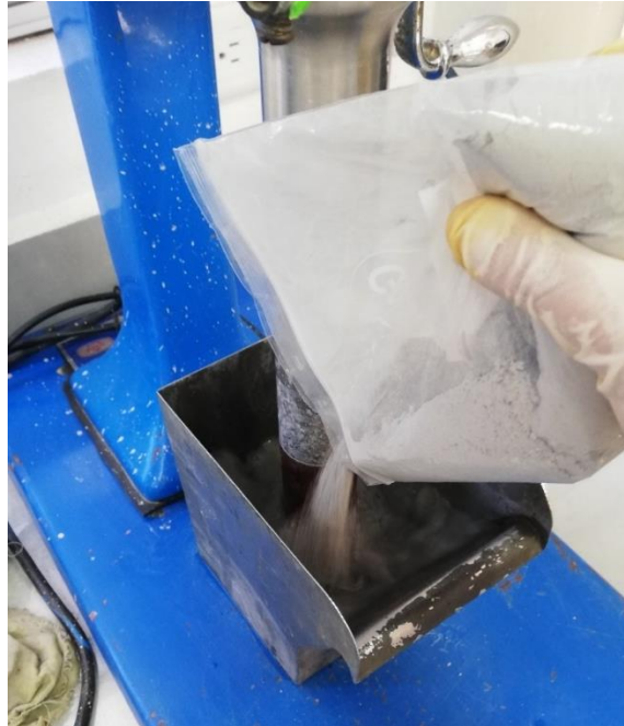
Figura 2.2 Preparación de la pulpa agregando el material aurífero
