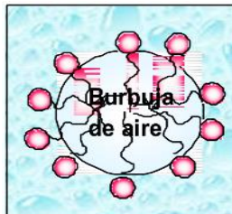
Figura 1.15 Adsorción del espumante: interface gas – líquido
