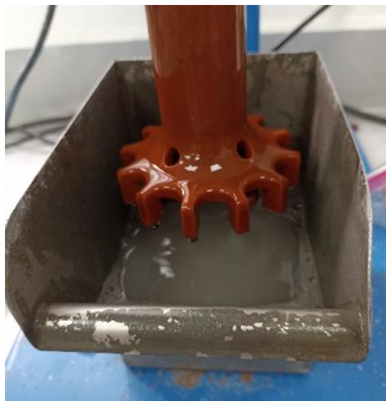
Figura 2.5 Relaves o colas resultantes del proceso de flotación
