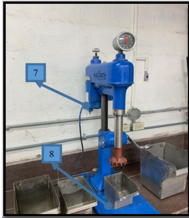
Figura 1.22 Celda de flotación Denver con sus principales partes
