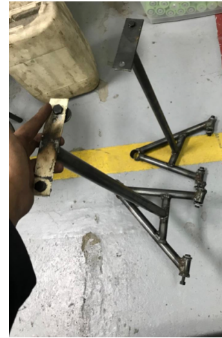
Fig. 18. Mecanismo que reemplaza amortiguadores
