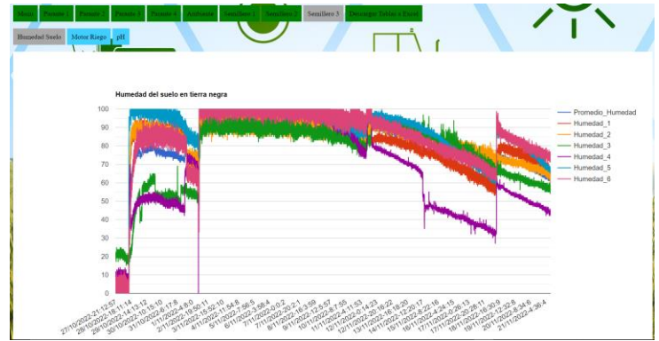
Figura 66. Comportamiento de los sensores de humedad en el semillero 3 con tierra negra.
