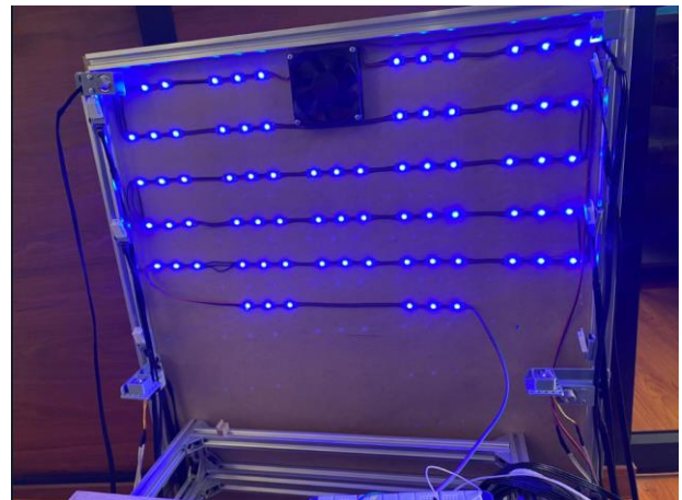
Figura 19. Iluminación y ventilación para el germinador.
