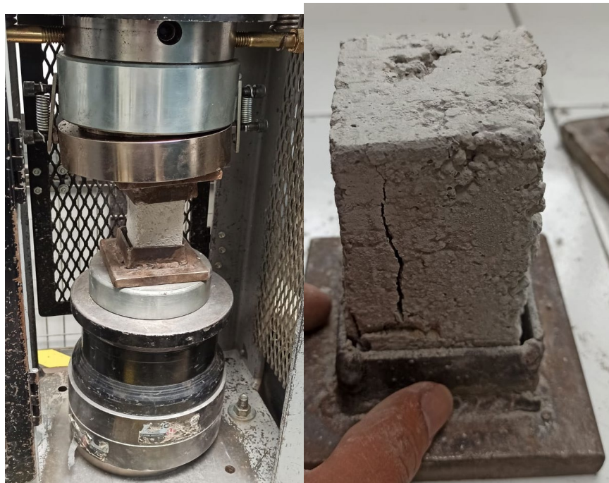
Figura 2.9. Fractura del bloque.
