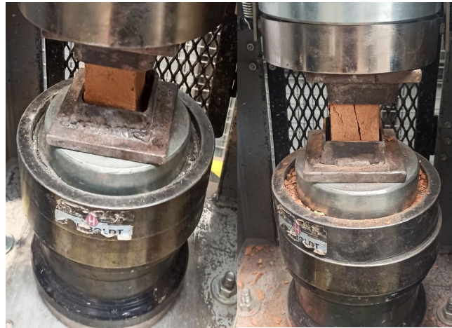
Figura 2.7. Fractura del ladrillo en la prensa.
