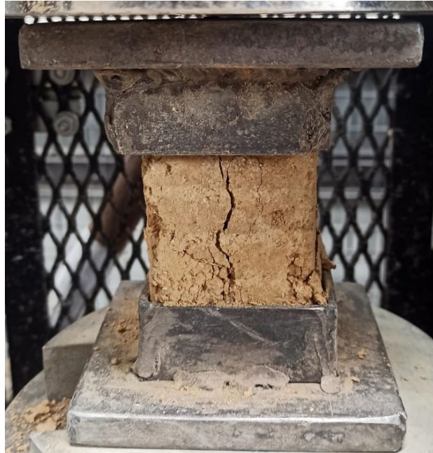
Figura 2.3. Fractura del adobe en la prensa.
