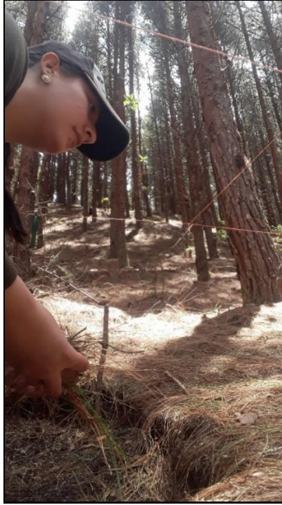
Anexo 7. Instalación y muestreo de los data loggers para la obtención de datos microclimáticos.
