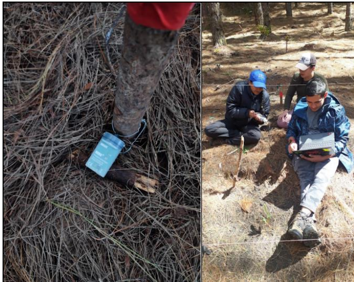
Anexo 7. Instalación y muestreo de los data loggers para la obtención de datos microclimáticos.
