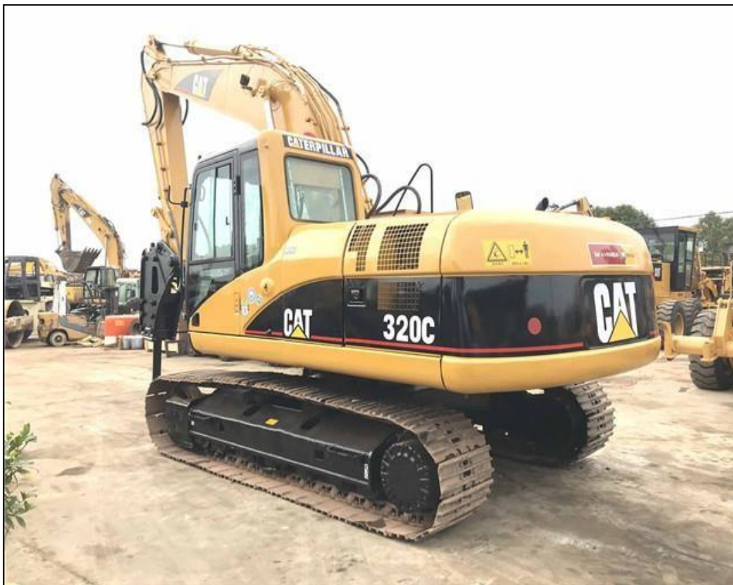
Figura 1.7 Retroexcavadora CAT 320 (Capacidad de cucharón de 1.19 m 3 )
