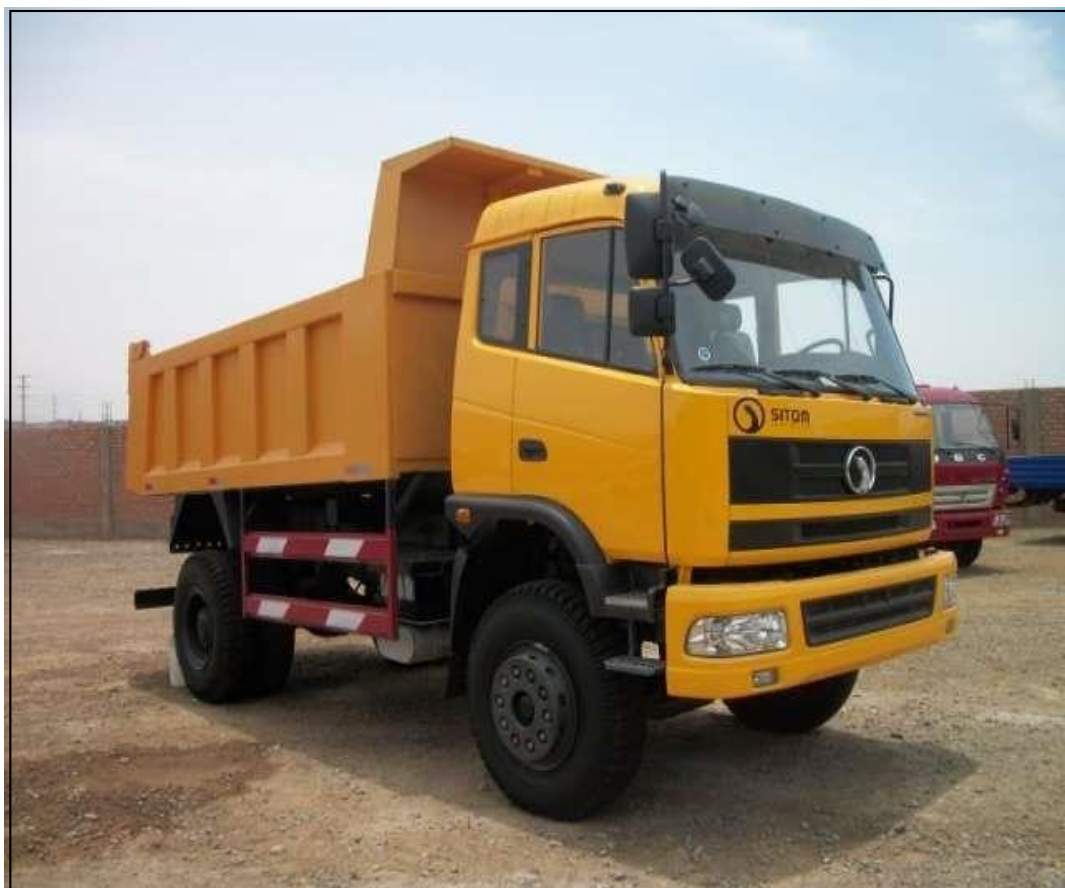
Figura 1.9 Dos volquetes de 8m 3 de capacidad de balde
