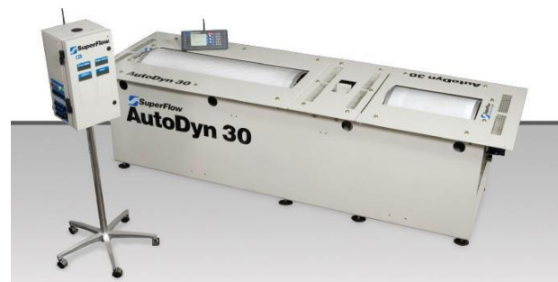
Fig. 5 Dinamómetro Superflow Autodyn 30 [15].
