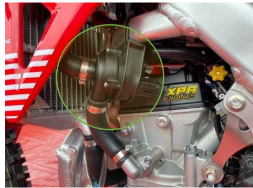
Fig. 1 Uso de bombas de agua eléctricas 2022 [11].
