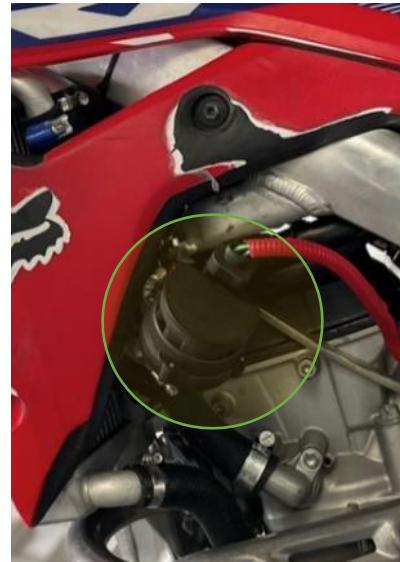
Fig. 12 Instalación de bomba eléctrica.
