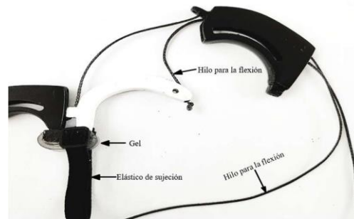
Fig. 14: Hilo de flexión de los módulos de los dedos.
