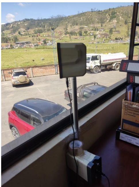
Figura 15: Colocacion de la Camara Count Cam para conteo de vehiculos
