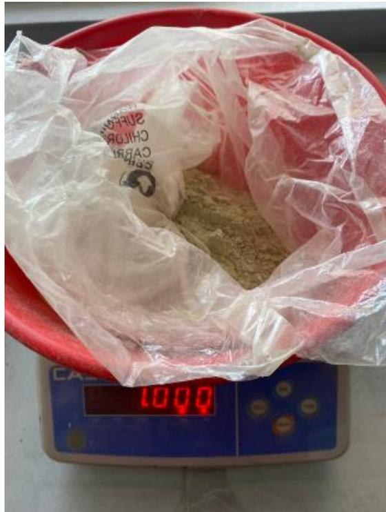
**Figura 2.3** Mezcla para la fabricación de adobes 1kg de muestra con adición de 25% de zeolita
