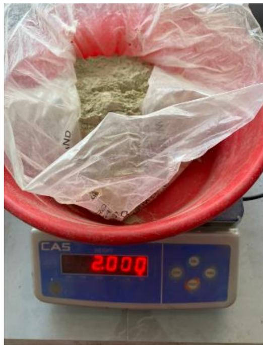
**Figura 2.2** Mezcla para la fabricación de adobes 2kg de muestra con adición de 50% de zeolita
