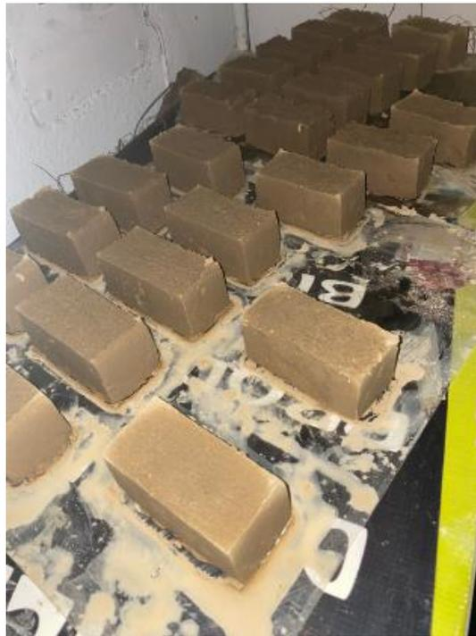
**Figura 2.7** Proceso de secado de muestras de adobe
