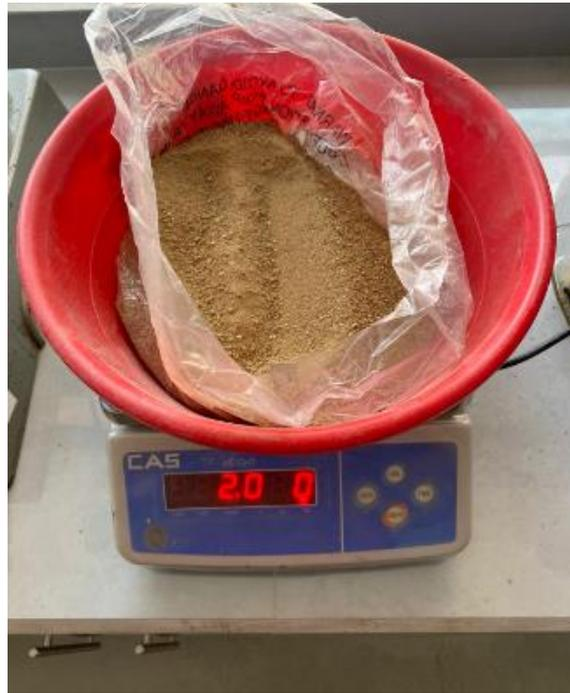
**Figura 2.1** Mezcla de arcilla para fabricación de adobe 2kg
