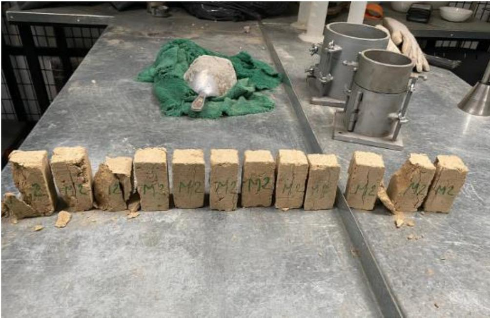
**Figura 2.9** Muestras #2 de adobe con adición del 25% de zeolita
