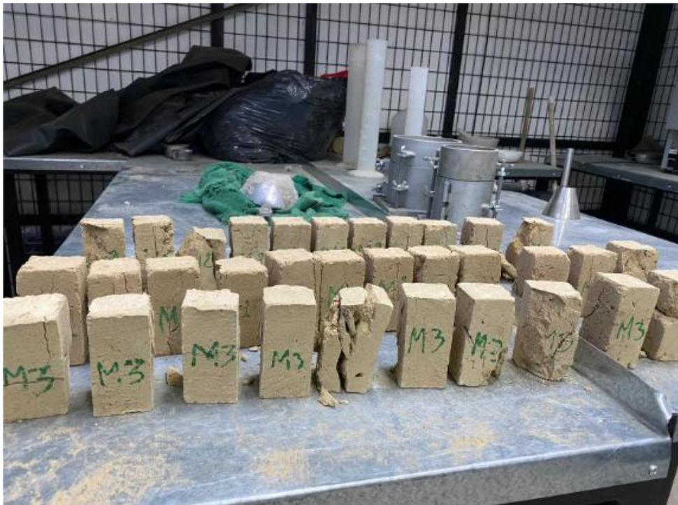
**Figura 2.10** Muestras #3 de adobe con adición del 50% de zeolita.
