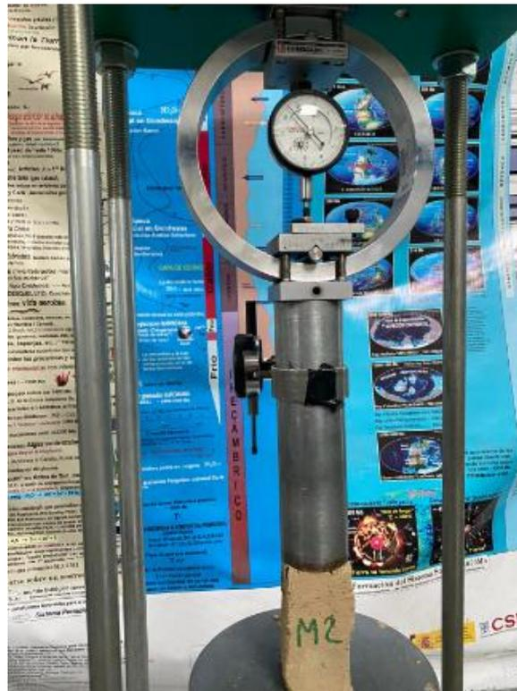
**Figura 2.11** Experimento de resistencia a la compresión simple de M2
