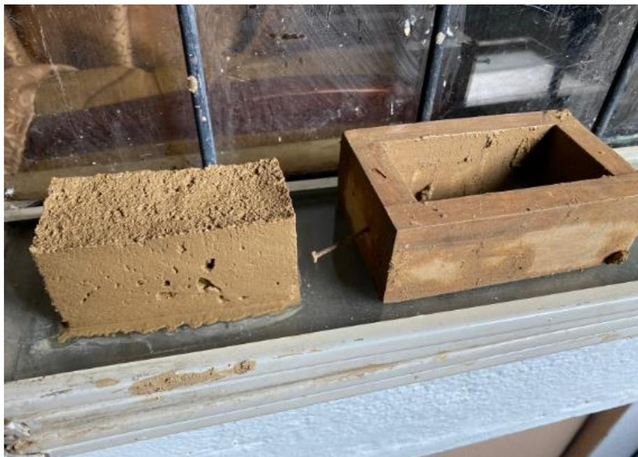
**Figura 2.4** Fabricación de adobes con los moldes estandarizados
