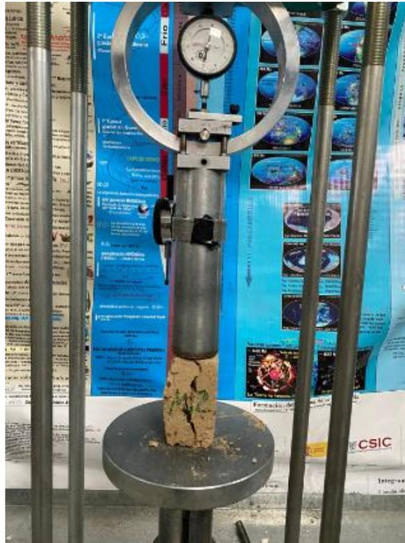
**Figura 2.12** Fractura por experimentación de la resistencia a la compresión simple de M2
