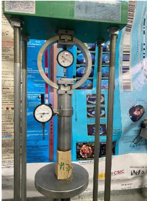
**Figura 2.14** Fractura por experimentación de la resistencia a la compresión simple de M3
