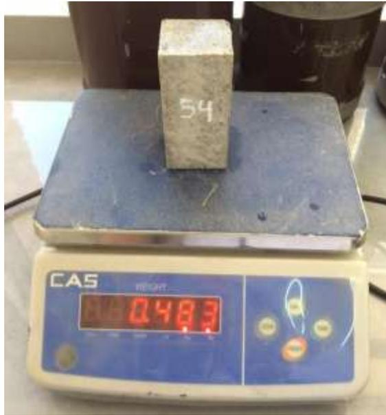
**Anexo 10.** Peso de la muestra de dosificación 1:4: zeolita, cemento, arena y agua.
