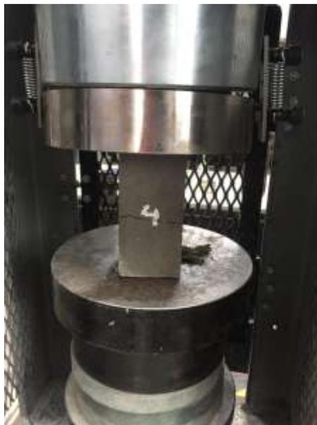
**Figura 2.17.** Rotura de la muestra 4 después de soportar la carga ejercida por la prensa hidráulica Humboldt.
