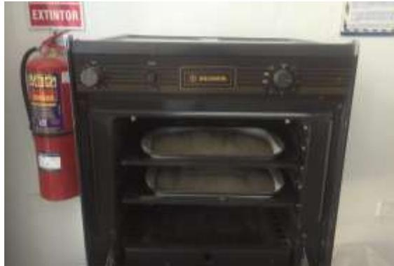
**Figura 2.3.** Secado de la arena a 100 °C.
