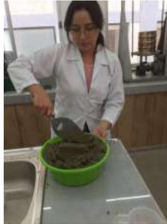
**Anexo 4.** Mezcla de la dosificación 1:2 de cemento, zeolita y agua.
