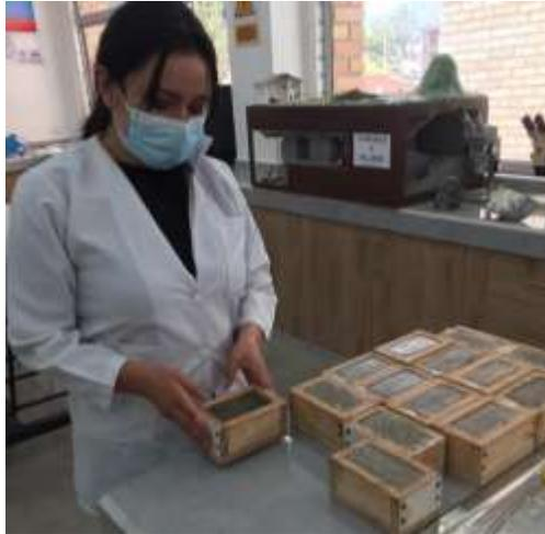
**Figura 2.8.** Compactación manual de la mezcla.
