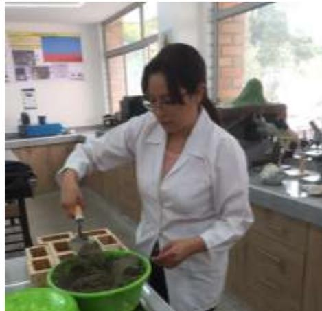
**Anexo 5.** Colocación de la mezcla en los moldes.
