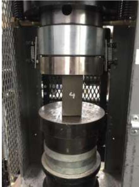
**Figura 2.16.** Muestra 4 colocada en la prensa hidráulica Humboldt.
