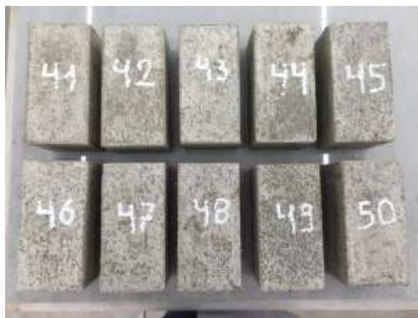
**Anexo 9.** Muestras de dosificación 1:3: zeolita, cemento, arena y agua.
