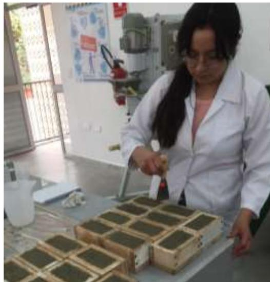
**Figura 2.9.** Uso de la espátula para aplanar la cara expuesta de los bloques.
