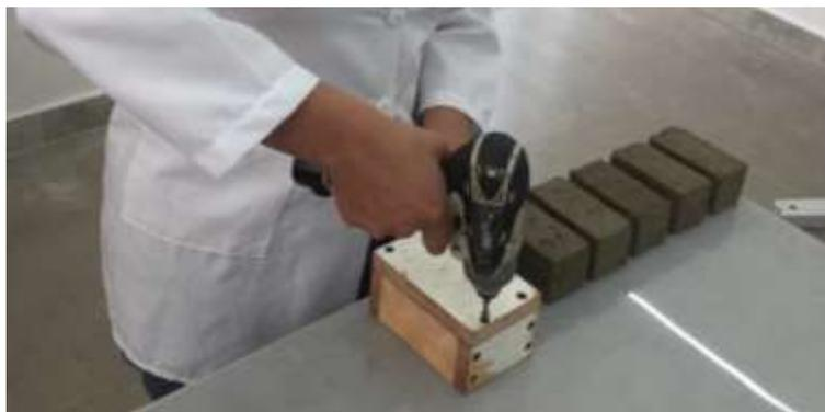
**Figura 2.11.** Desencofrado de los moldes.
