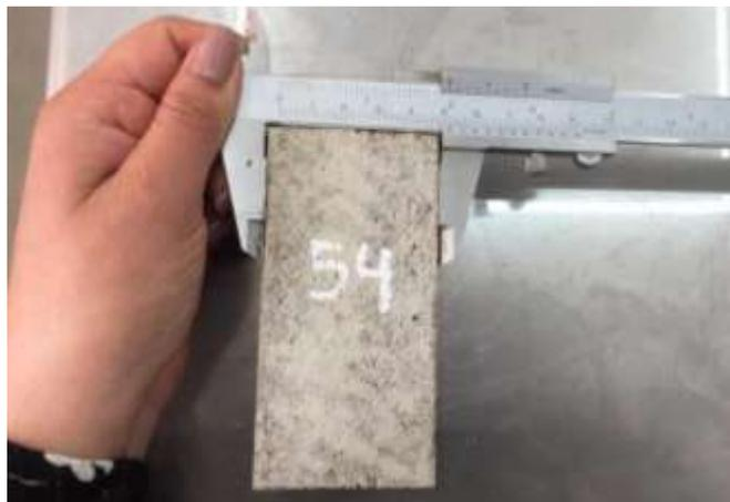
**Figura 2.15.** Medición de muestras con el pie de rey.
