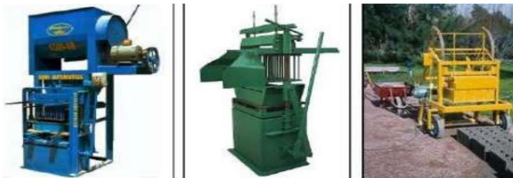
**Figura 1.8.** Máquinas para el moldeado de bloques.
