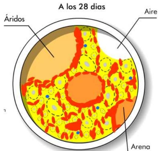
**Figura 1.5.** Comportamiento del cemento a los 28 días.
