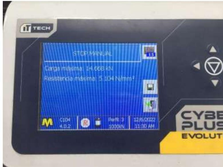
**Figura 2.18.** Resultados obtenidos luego de la rotura de la probeta.
