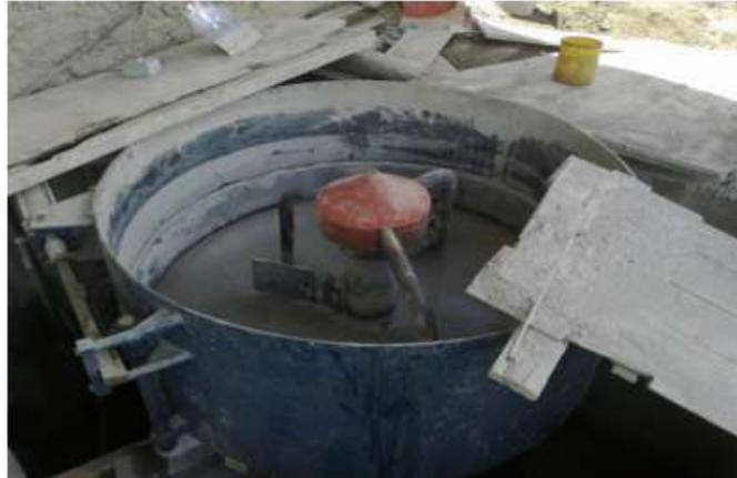
**Figura 1.7.** Mezcladora para fabricar bloques.
