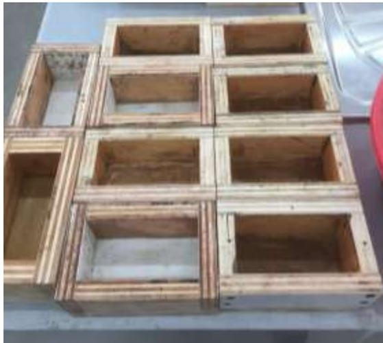
**Figura 2.6.** Colocación del desmoldante.
