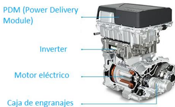
Figura 6. Ensamblaje del tren de propulsión del Nissan Leaf ZE [10]
