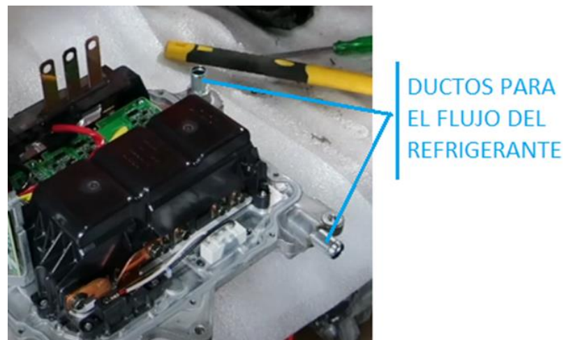
Figura 8. Ductos de refrigeración del inversor [10]
