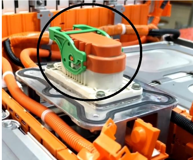
Figura 18. Interruptor de servicio (Acoplado sólo para fotografía)
