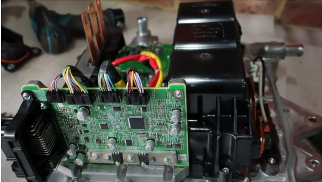
Figura 10. Inversor desmontado y sin cubierta [10]
