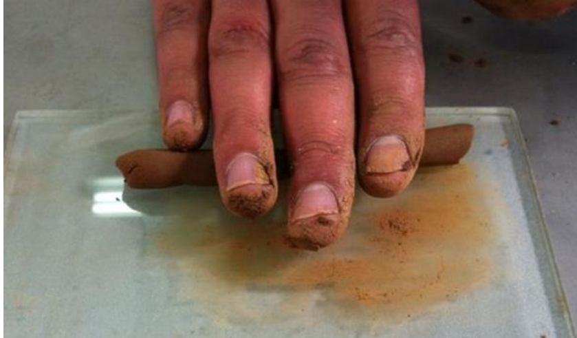
Imagen 5: Muestra de suelo en la cual empiezan a aparecer grietas y fisuras (masa de pan imperfecta)
