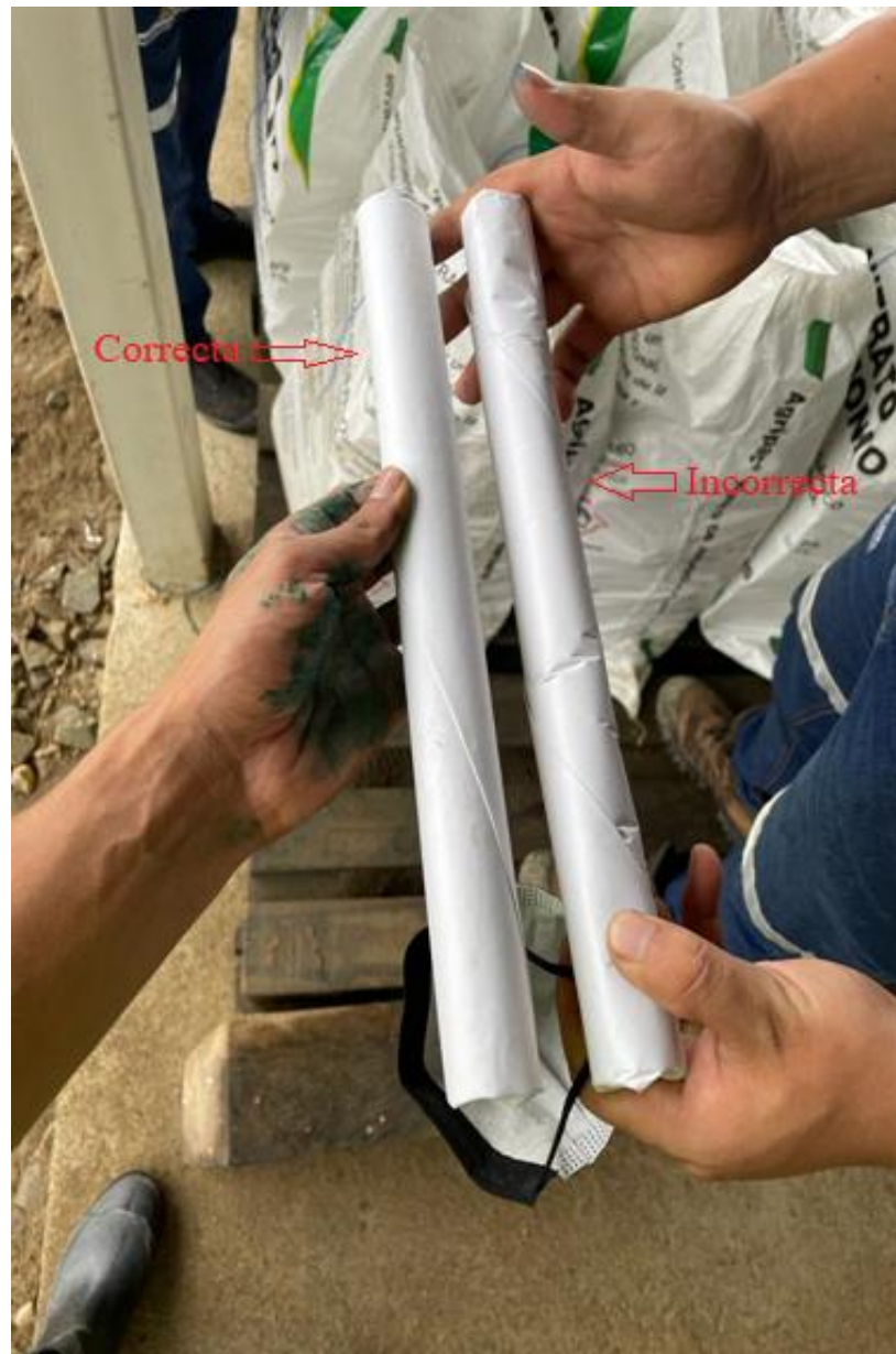
Anexo 3. Correcta e incorrecta forma de preparación del taco de nitrato.
