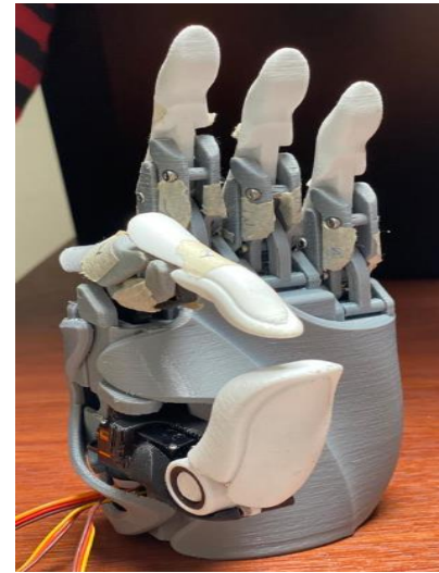
Figura 40 Prótesis construida con filamento PLA. Fuente: Propia
