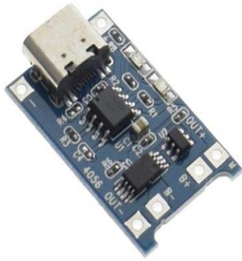
Figura 31 Módulo de carga tipo C.
