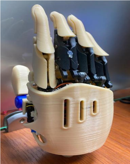
Figura 42 Prótesis construida con filamento TPU flexible. Fuente: Propia
