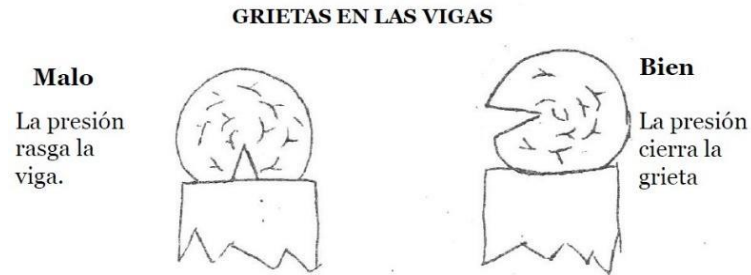
Figura 1.3 Grietas en las Vigas
