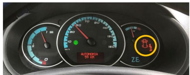
Fig. 23 Cluster activado modo de conducción ECO.
