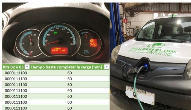
Fig. 25 Tiempo hasta completar la carga del EV con enchufe de carga conectado.
