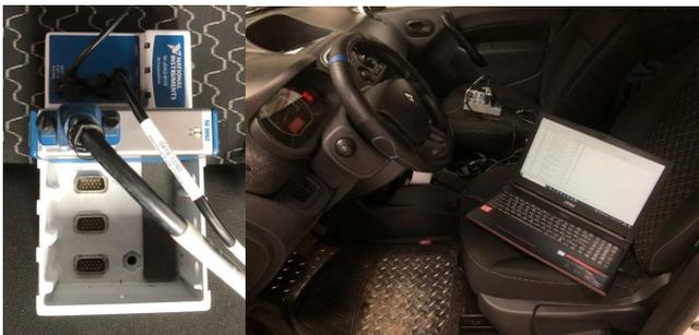
Fig. 13 Tarjeta de adquisición de datos NI 9862 conectado al EV monitoreado por programa XNET Bus Monitor.
