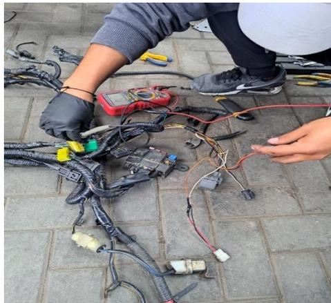
Después de realizar las comprobaciones con todos los conectores se empieza a abrir el cableado para arreglar los cables que estén ya sea sulfatados o cortados y reemplazarlos como se muestra en la figura 18.
