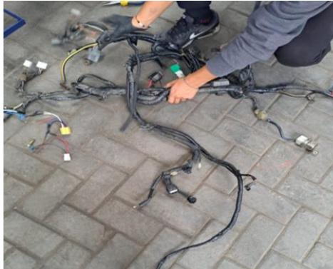
Una vez desmontado el arnés se comprueba que no existan cables cortados, con ayuda de un multímetro se coloca en la opción de continuidad y se coloca una punta del multímetro en los conectores de los sockets y la otra punta a los conectores de la computadora, del tablero y del switch de encendido para comprobar que el cableado este en buen estado como se muestra en la figura 17.
