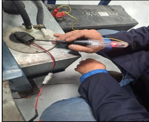
Durante la inspección, también se prestó atención al funcionamiento y estado de cada uno de los componentes. Se llevaron a cabo pruebas y mediciones para determinar si los sensores estaban generando lecturas precisas y si los actuadores responden correctamente a las señales de control. Además, se examinaron visualmente los componentes en busca de señales de desgaste, corrosión o daños físicos que pudieran afectar su rendimiento.
