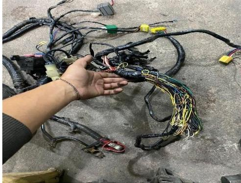
Por último, ya arreglado todo el cableado se empieza a encintar para proteger y ordenar los cables, se utilizo cinta aislante y cinta de tela en todas las ramas del arnés, ya acabado de encintar, colocamos el tubo anillado en todas las partes del arnés y encintamos por fuera del mismo para que quede estable y no se salga, al final colocamos el arnés de manera que sea vea estético con ayuda de bridas plásticas como se aprecia en la figura 19.
