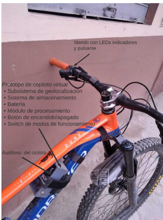
Fig. 10 Prototipo de copiloto virtual implementado
