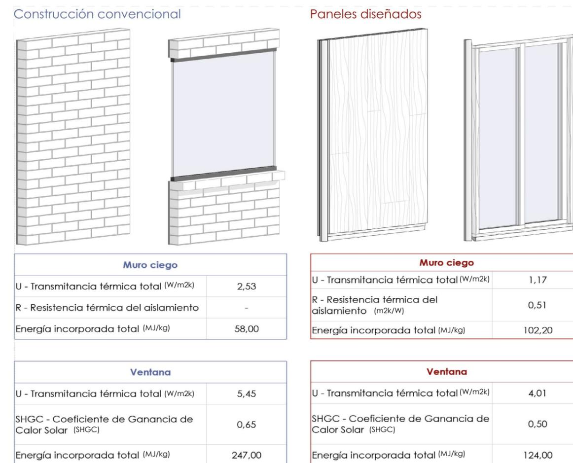
Fig 96: Resultados correspondientes a muro ciego y ventana de construcción convencional. Fuente: Autoría propia.
