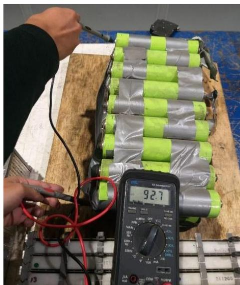
**Figura. 2.** Comprobación de voltaje de baterías. Fuente: Autores.
