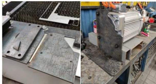
Figura 22: Mecanizado de soportes del motor de imanes permanentes.
