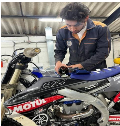
Figura 23 Llenado del depósito de combustible.
