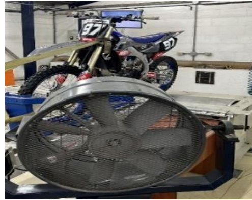
Figura 9 Ventilador de enfriamiento.
