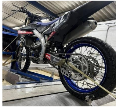
Figura 7 Motocicleta sujeta en el dinamómetro.
