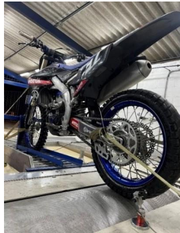
Figura 20 Sujeción de la motocicleta en el banco dinámico.
