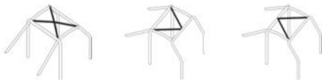
Figura 5 Tirantes de refuerzos en los arcos principales. Fuente: (FIA, 2014, pp. 253-1)
