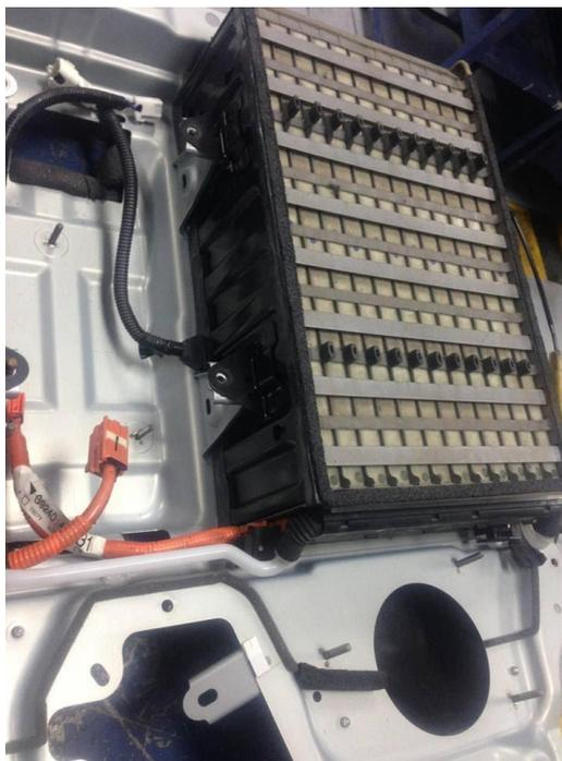
**Figura 28** *Conexión y desconexión de baterías del vehículo híbrido*
