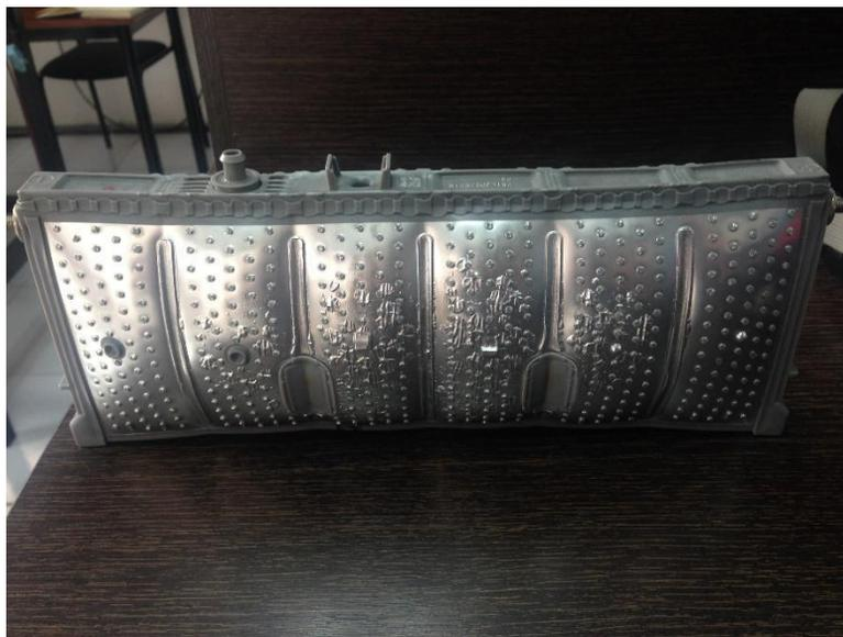
Para evitar errores durante el proceso de desmontaje, es recomendable enumerar las celdas de acuerdo a su posición, comenzando con el número uno, que se encuentra en el lado más cercano del fusible de seguridad. De esta manera, se podrá identificar rápidamente cualquier celda crítica o defectuosa durante el proceso de desacoplamiento del paquete de celdas.
