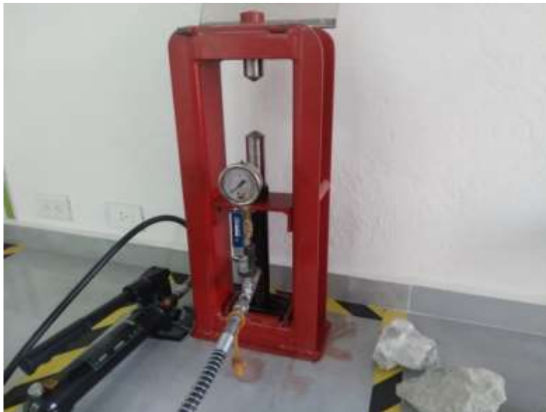
Figura 12 Colocación de muestras para la compresión Is50
