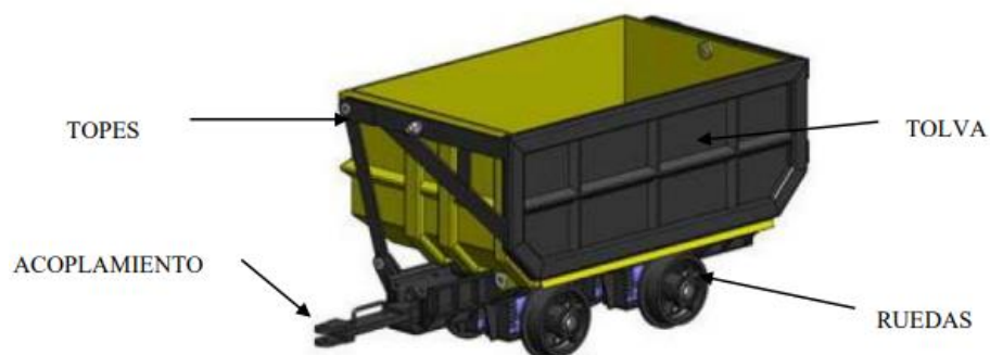
Figura 13. Carro minero y sus partes
