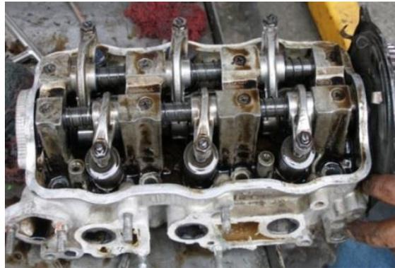
Nota: cabezote con el eje de levas de circuito
