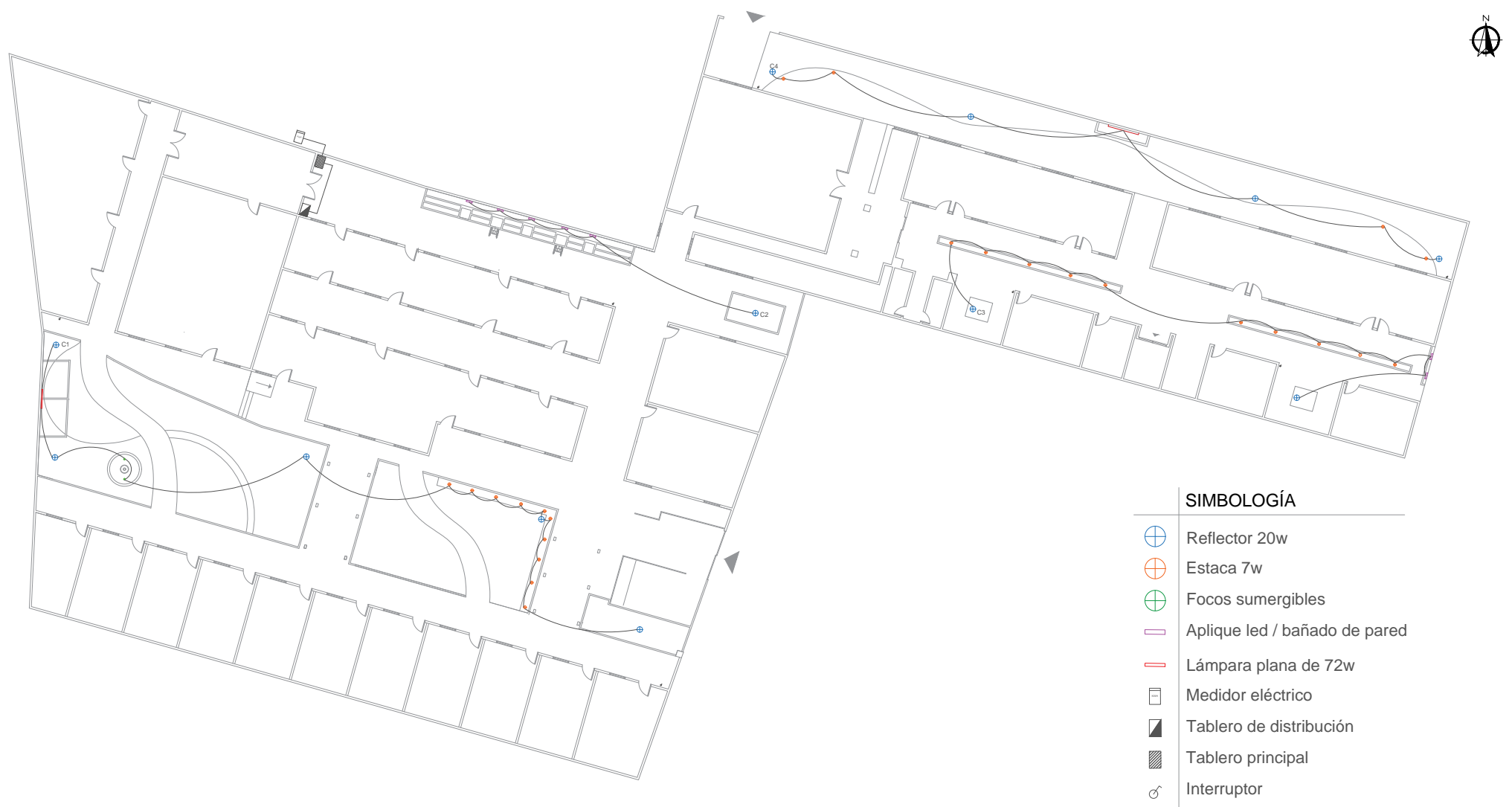
Imagen. 76 Planta de instalaciones electricas.(Redrován, 2024).
