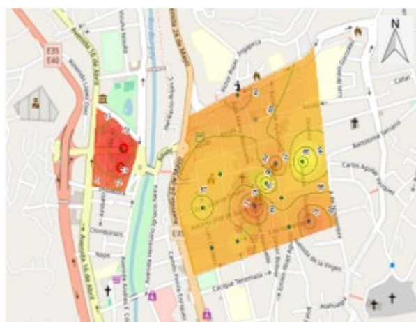
Figura 11. Mapa de ruido en el horario de 10:00 a 11:00 am, donde se evidencia niveles de ruido de 71,53 dB en la intersección de las calles Antonio José de Sucre y Matovelle.
