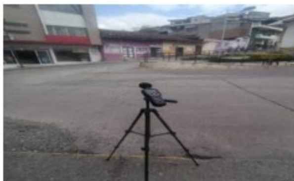
Figura 3. Ubicación del sonómetro en las intersecciones de las calles para toma de datos cumpliendo con la norma IEC 61672.
