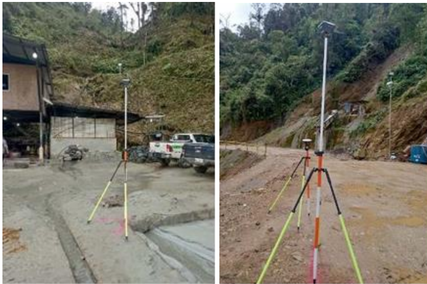
Figura 10. Levantamiento topográfico en superficie de la Concesión
